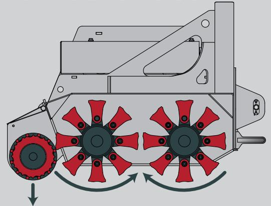
Der PlanierProfi zerkleinert die auf der Grasnarbe liegenden Grassoden und verfüllt mit der zerkleinerten Erde die Unebenheiten. Zusätzlich wird der Boden durch das **Vertikutierprinzip** belüftet, sodass ein dichter Grasbestand nachwachsen kann.
