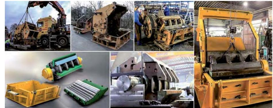
**VERSCHLEISSITUATIONEN** werden analysiert und im Sinne des Kunden nach der bestmöglichen Lösung gesucht. Wie umfangreich die Verjüngungskur unter Einsatz von Cracox-Stählen und Gussteilen sein muss, wird immer von Fall zu Fall entschieden.
