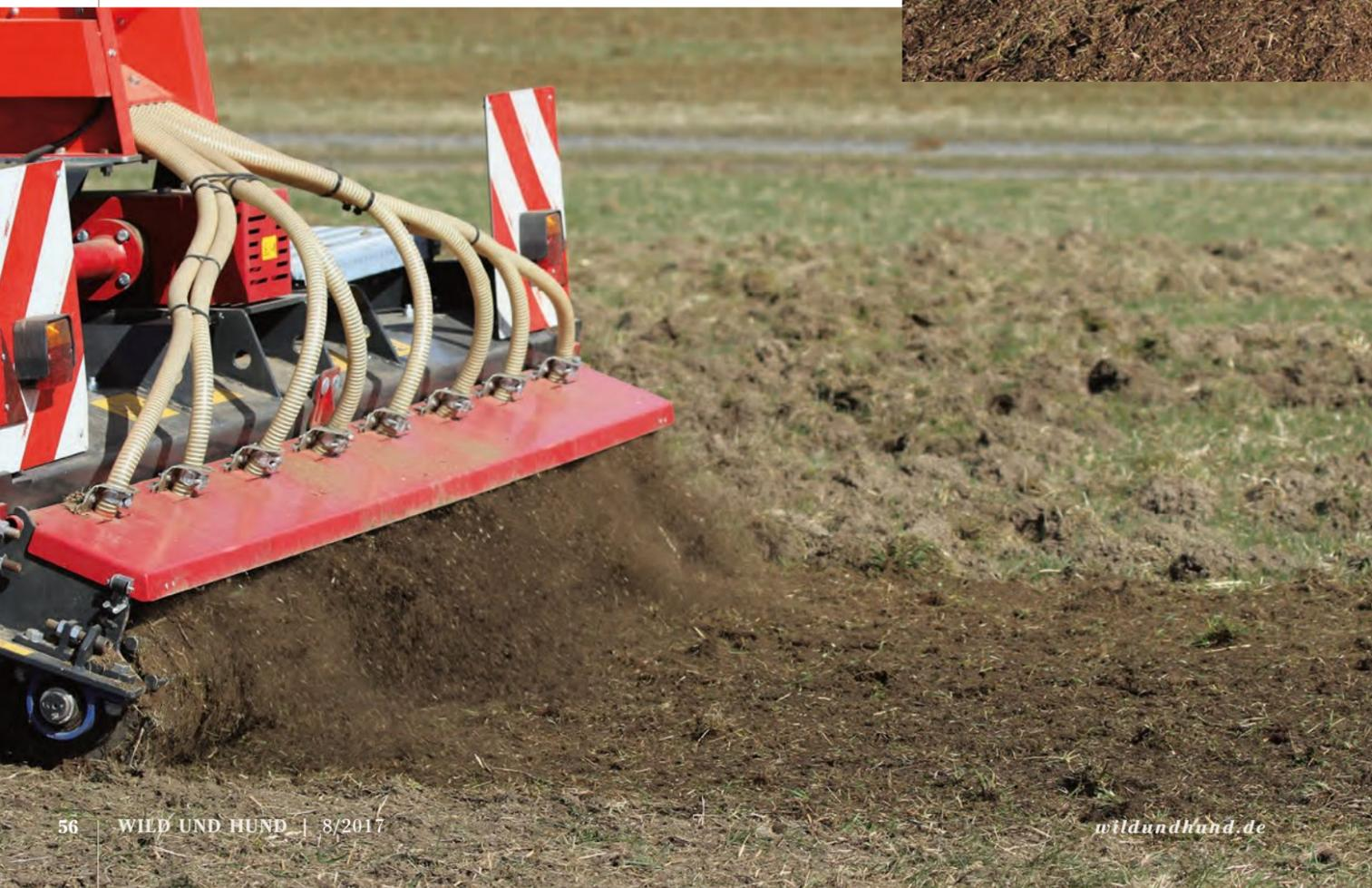
**Wie die Vorführung** eindrucksvoll zeigt, ist nur ein Arbeitsgang nötig, um ein Top-Ergebnis zu erhalten. Das spart Maschinenstunden und damit Geld. Je nach Geländebeschaffenheit ist eine Arbeitsgeschwindigkeit von fünf bis sieben Stundenkilometern üblich. Somit sind Flächenleistungen von einem Hektar pro Stunde drin.
