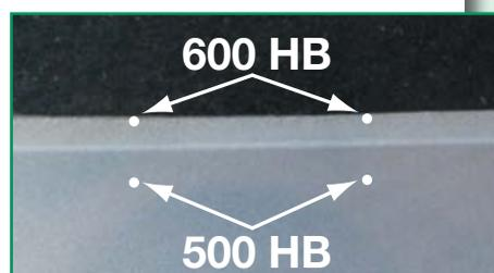
Geschliffene und geätzte Probe.
